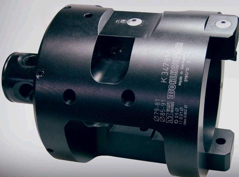
Überdreh-Schllichtbearbeitung Ø 80<sup>k6</sup> und Ø 90<sup>k6</sup> mit Kantenbruch am Zapfenende, Bearbeitungslänge 153 mm
